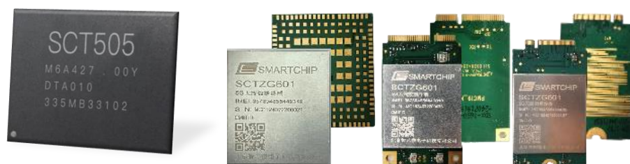
自主研制的 5G RedCap 的芯片与 5G RedCap 模组
