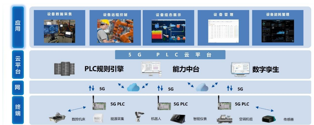
基于 5G PLC 的“终端+云网+平台+应用”解决方案架构图
