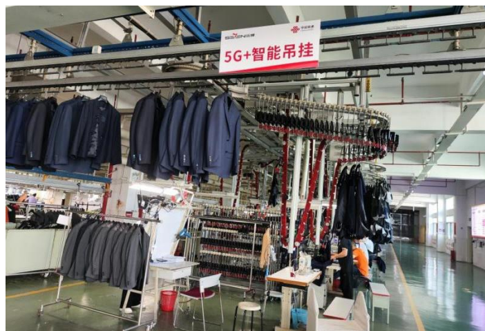
5G+全生产智能物流系统-吊挂系统
