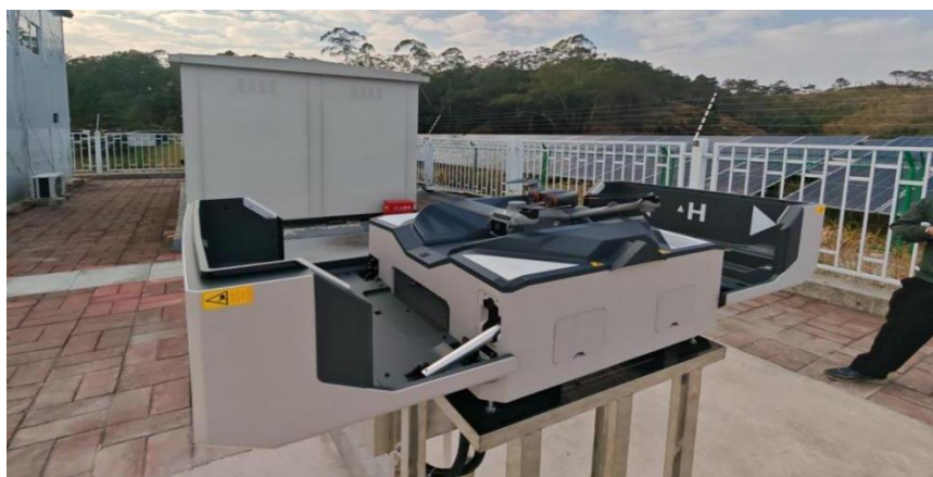
5G+无人机巡检场景中的无人机设备
