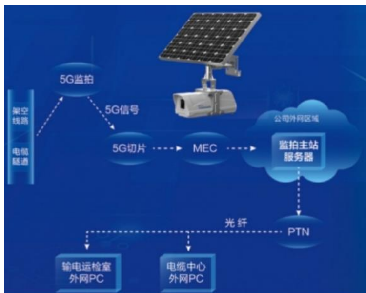
图 3-46 基于 5G 的电力线路监测
