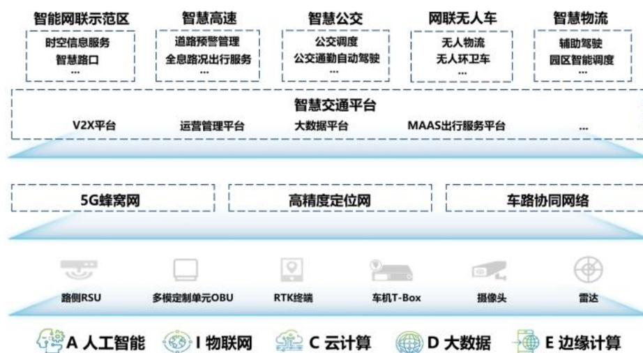
图 3-15 5G+车联网总体架构
