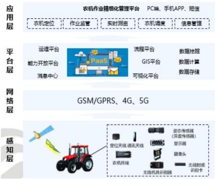
图 3-73 网联农机系统示意图
