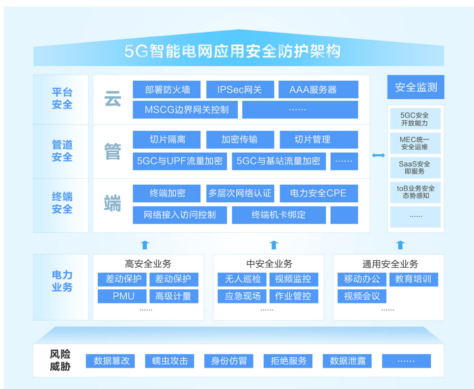
图 3-2 5G 电力虚拟专网总体安全参考架构
